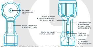
Фонарь может использоваться как фонарь прожектор, так и как кемпинговый фонарь. Для включения фонаря воспользуйтесь одной из двух кнопок-переключателей, расположенных последовательно друг за другом на рукояти фонаря. Длительное нажатие на кнопку включения рассеянного света включает панель красного света. Головная часть может поворачиваться на 90 градусов вокруг оси и фиксируется в 5 промежуточных положениях. На рукояти фонаря расположены два отверстия для крепления плечевого ремня.
